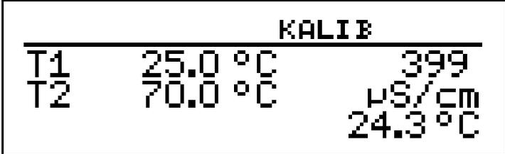
Das LC-Display zeigt jetzt rechts die Leitfähigkeit (399 µS/cm) bei der aktuellen Temperatur (24.3°C).
