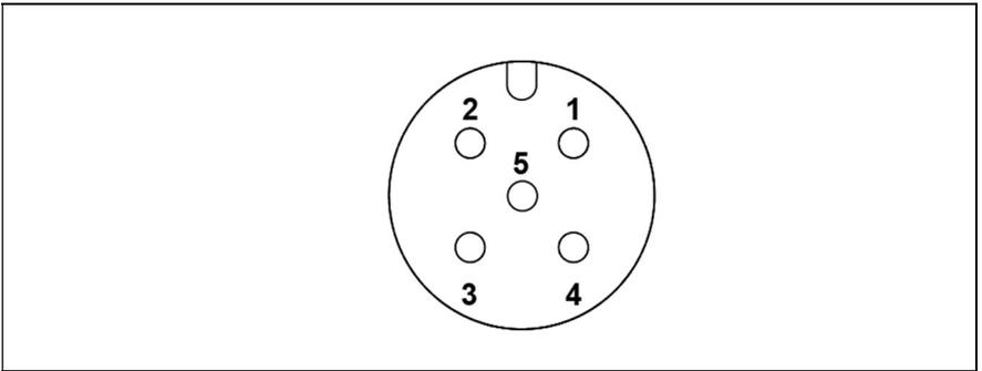
Abb. 9: Anschlussbelegung (5-polig)
