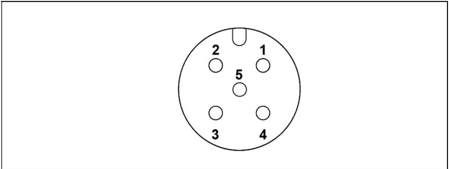
Abb. 11: Anschlussbelegung (5-polig)
