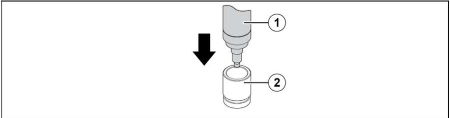
Abb. 7: Sensorkörper aufsetzen
